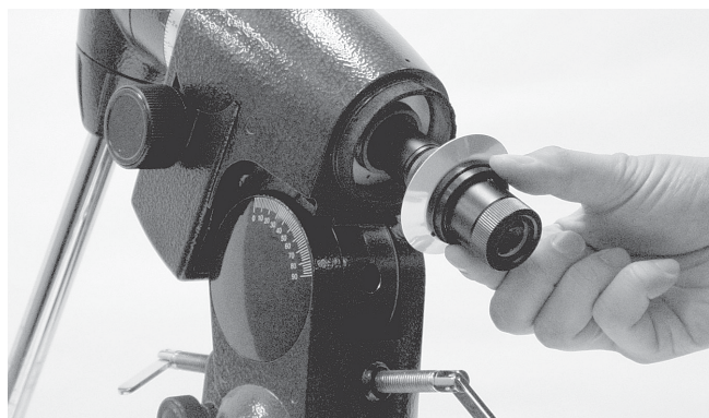
Figura 7b. Installazione del cercatore dell'asse polare opzionale.
