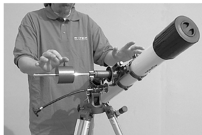
Figure 3b. Le télescope est maintenant en équilibre sur l'axe d'ascension droite. Autrement dit, l'axe de contreponds reste horizontal lorsque vous le lâchez.
