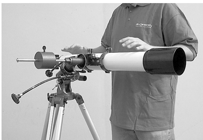
Figure 3e. Le télescope est maintenant équilibré sur l'axe de déclinaison, autrement dit, il reste horizontal lorsqu'on le relâche.
