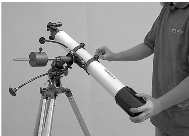
Figure 3d. Équilibrage du télescope par rapport à l'axe de déclinaison. Comme on le voit ici, le télescope est déséquilibré (inclinaison).
