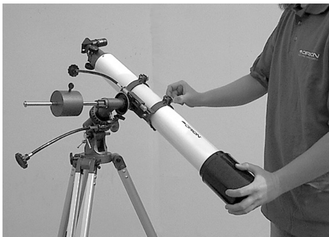
Figura 3d. Equilibrado del telescopio con respecto al eje de declinación. Como se muestra aquí, el telescopio está desequilibrado (inclinación).
