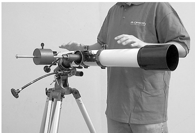
Figura 3e. El telescopio está ahora equilibrado sobre el eje de declinación, es decir, se mantiene en posición horizontal cuando se sueltan las manos.
