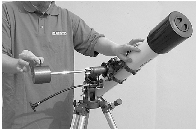
Figura 3a. Equilibrado del telescopio con respecto al eje de A. R. deslizando el contrapeso a lo largo de su eje.
