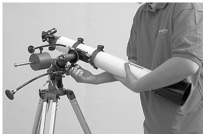
Figura 3c. Preparación del telescopio para equilibrarlo en el eje de declinación liberando antes el botón de bloqueo de declinación.
