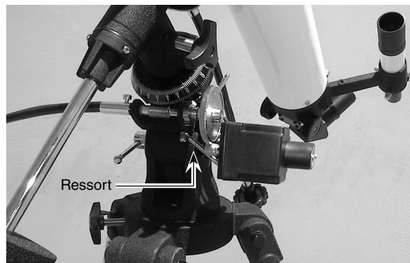
Figure 6. Le moteur EQ-2M correctement installé sur la monture EQ-2
